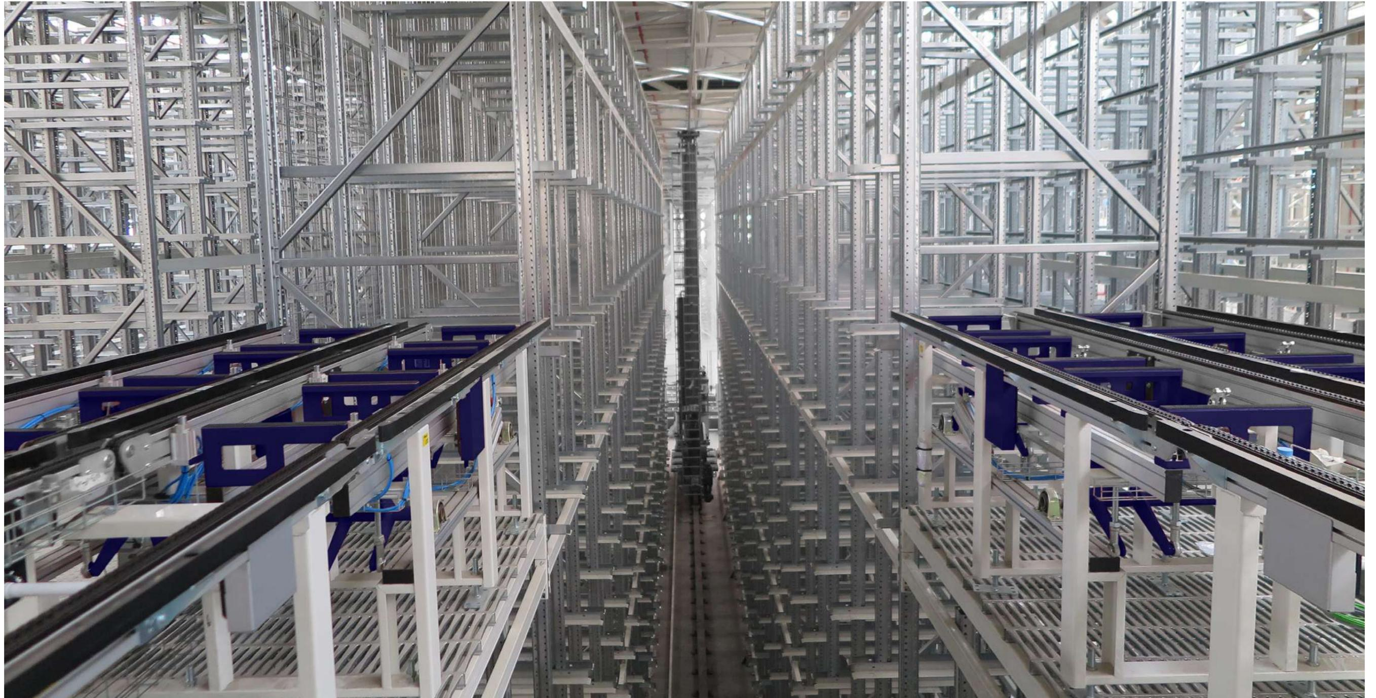
Le scaffalature Sacma per impianti miniload si adattano perfettamente a stoccare scatole di ogni dimensione, sia in singola che in multiprofondità, fino ad un
