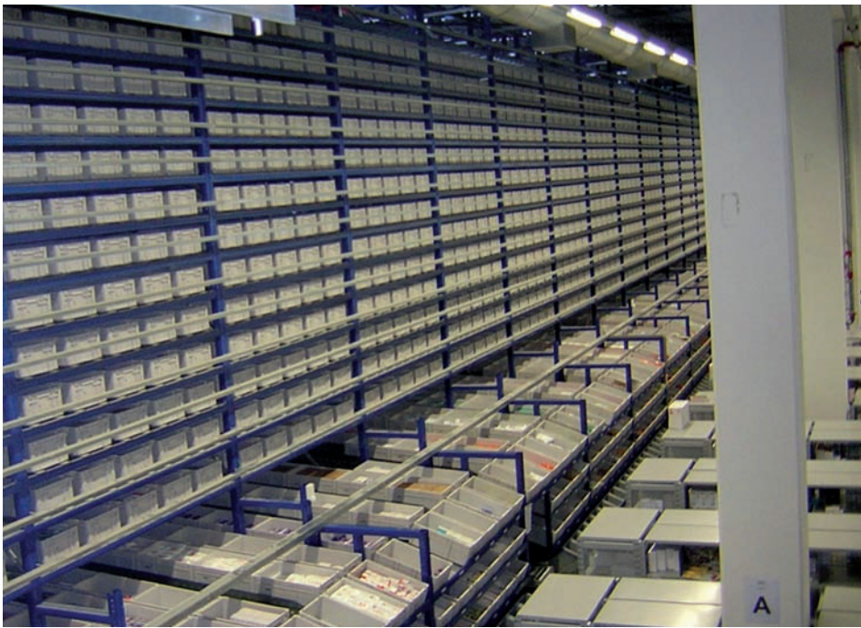
Figura 5 - A sinistra canali a gravità riforniti dal trasloelevatore, a destra le strutture a ripiani.
