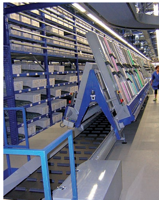
Figura 4 - Particolare di un dispenser ad “A” con rifornimento automatizzato.
